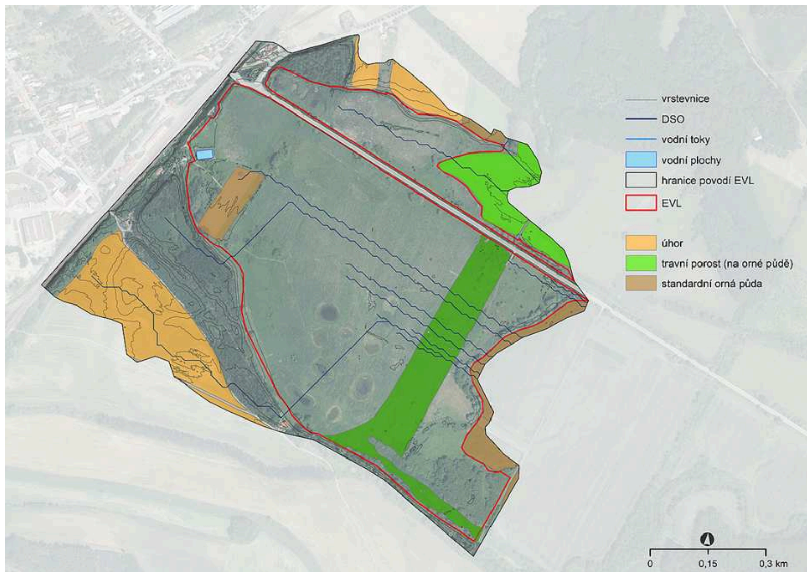
Obr. 87. Analýza využití půdy a základní hydrologie v povodí EVL Vypálenky.
